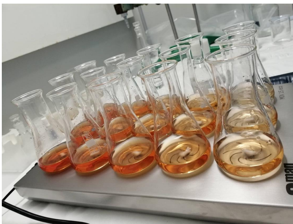
Slika 9. Sintetiziranje selenovih nanočestica (Foto: B. Ravnjak)
